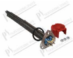
Boilerheizkörper 5500W 220/380 - 6543W 240/415V [KIT] L=365 mm; dreieckförmigen Flansch 83,5x78,5 mm; Øint. 47 mm; mit Thermostathülsen L=175 mm; Anschluss M4
