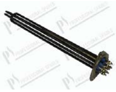
Boilerheizkörper 4500W 220/38V 5355W 240/415V L=335 mm; dreieckförmigen Flansch 83,7x78,8 mm - Anschluss M4 mit Thermostathülsen L=175 mm;
