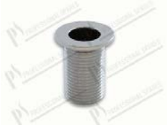
Ablaufventil 1/2" - H=37 mm Øint 16 mm
