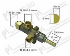
Gashähne CAL-3200 eingang gas M18x1,5; Anschluss Thermoelement M8x1; Halbmondachse Ø 10x8 mm; Schraube mindest Ø 1,20 mm
