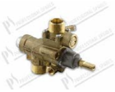
Gashähne mit Sicherheit PEL 23SV mit Zündflamme und vertikalen Flansch; Eingang M28x1,5; Ausgang M24x1,5 mm; Anschluss Thermoelement M10x1 mm; Halbmondachse Ø 10x8 mm L=25 mm; Schraube mindest Ø 2,20 mm
