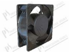
Kompaktlüfter 120x120x38 mm - 20W 230V 50/60Hz ohne kabel; flachstecker 2,8x0,5 mm; 2550 rpm; Kugellager
