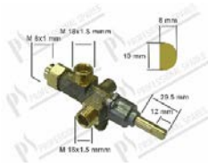
Gashähne CAL-3200 eingang gas M18x1,5; Anschluss Thermoelement M8x1; Halbmondachse Ø 10x8 mm; Schraube mindest 0,90 mm
