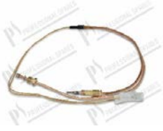
Thermoelement Unterbrecher M9x1L=220 mm Kabel L=300 mm
