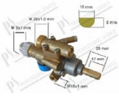
Gashähne mit Sicherheit PEL 22SO mit Zündflamme und horizontalen Flansch; Anschlüsse M20x1,5 mm; Anschluss Thermoelement M9x1 mm; Halbmondachse Ø 10x8 mm L=25 mm
