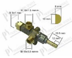
Gashähne CAL-3200/011.55 eingang gas M18x1,5; Anschluss Thermoelement M8x1; Halbmondachse Ø 10x8 mm; Schraube mindest Ø 0,55 mm
