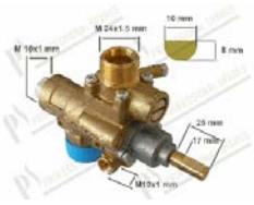
Gashähne mit Sicherheit PEL 23SV mit Zündflamme und vertikalen Flansch; Eingang M28x1,5; Ausgang M24x1,5 mm; Anschluss Thermoelement M10x1 mm; Halbmondachse Ø 10x8 mm L=25 mm
