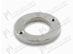
Scheibe Ø 22x36x4 mm Gewinde M3
