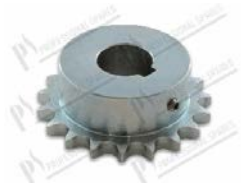
Zahnrad Ø 82 mm - 19 Gebiss Øint. 25 mm; für keil 8 mm
