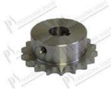
Zahnrad Ø 76 mm - 18 Gebiss Øint. 20 mm; für keil 6 mm
