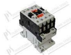
Schütz BF901A230 4,2kW 3P; 230ACV 50Hz 400V 3 cont. NO + 1 aux NO
