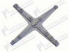
Wasch/Nachspülarm 410x410 mm 6 Düse wasch e 4 Düse Nachspül - LBC-BHC
