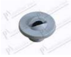
Washing nozzle F45/55 Øint. 9,8 mm, Øext. 14/27,5 mm, H=18 mm
