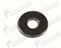
Flat washer M6 Ø 6,6x18x1,6 mm INOX
