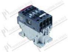
Contacteur A9-30-10 4kW 3P; 24VAC 50/60Hz; 400V 3 cont. NO + 1 aux NO; dim. 75x43x72 mm
