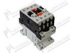
Contacteur BF901A230 4,2kW 3P; 230ACV 50Hz 400V 3 cont. NO + 1 aux NO
