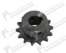
Pignon - 14 dentée Øint. 20 mm; pour clavette 6 mm
