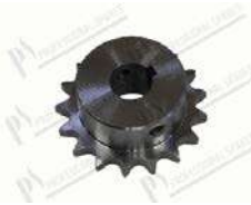
Pignon - 17 dentée Øint. 20 mm; pour clavette 6 mm
