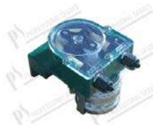
Doseur péristaltique lavage débit rég. temps-pause mod. G300; débit maxi 3,0 lt/h; 230V 50Hz; tuyau Ø 5x8 mm
