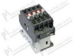
Contacteur A12-30-10 230V 7,5kW 3P; 220-230V 50HZ 240V 60Hz 3 cont. NO + 1 aux NO
