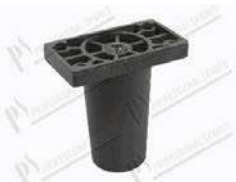
Pied fixe en plastique H=116,5 mm bride 109x60 mm; fileté M10
