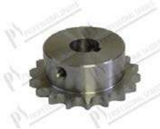
Pignon Ø 76 mm - 18 dentée Øint. 20 mm; pour clavette 6 mm
