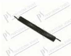
Ressort de torsion Ø fil 4 mm; Ø 31x255xLtot. 325 mm
