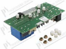
Scheda display IR 2 zones dim. 75x150 mm
