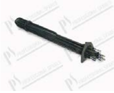
Heizkörper boiler 9000W 400V L=450mm, flansch 83x83 mm Øint.83mm; Anschluss F6,3
