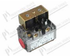
Gasventil 830 TANDEM Ø 1/2''FF - 230V 50Hz mit PR Pmax Eingang gas 60 mBar; P-Ausgang 3+50 mBar; Anwendungstemperatur 0+60°C
