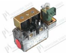
Gasventil 836 TANDEM Ø 1/2''FF - 230V 50Hz 230V RAC Pmax Eingang gas 50 mBar; P-Ausgang 2+45 mBar; Anwendungstemperatur 0+60°C
