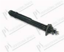
Resistenza boiler 9000W 400V L=450mm, flangia 83x83 mm Øint.83mm; attacco F6,3
