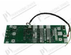
Scheda interfaccia Lev. C da Sn. 120 mod FCZ-AOS 061, 062, 101, 102, 201, 202
