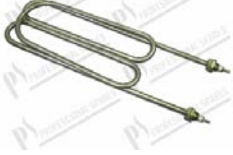
Tankheizkörper 4000W 220V Anschluss M14
