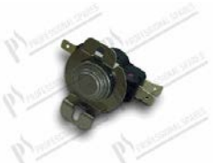
Anlegethermostat 52-60°C 60L50F mit gelb/bruin; kontakte C-2=NC; kontakte C-1=NO arbeitslager 30/46°C; 16A 250V
