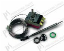
Thermostat arbeitsbereich 1P 30÷110°C kapillar L=3000 mm; Birne Ø 6x112 mm; mit Stopfbuchse M9x1
