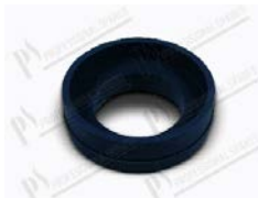
Gleitring für Wascharm unten Ø 54,6x16,6 mm, Øint.45,5 mm
