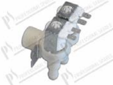
Magnetventile 90° - 2 wege - 220/240V 50/60Hz - Ø 14 mm mit Flachstecker; Eingang Ø 3/4" mit filter und Druckverminderer da 10 lt/min; Tmax 90°C
