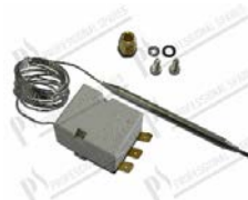
Thermostat arbeitsbereich 1P 30÷90°C kapillar L=1250 mm; Birne Ø 6x113 mm; 15A 250V
