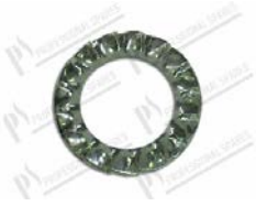
Tooth lock washer M10 Ø 10,5x18 mm DIN 6798A
