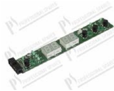
Interface board Electron 500 dim. 175x30 mm
