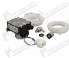
Bomba peristaltica detergente mod. NPG-3; portata fissa 3 L/h; 0,1 bar; 230V 50Hz; cavetti L=200 mm; tubo in Santoprene; completa di kit di montaggio
