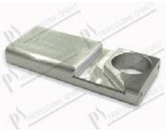
Soporte bisagra izquierda 100x42x15 mm desde SN. 246... agujero Ø 25,7 mm
