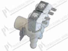
Electrovanne 90° - 2 voies - 220/240V 50/60Hz - Ø 14 mm avec fastons; entrée Ø 3/4" avec filtre et reducteur de pression 10 lt/min; Tmax 90°C
