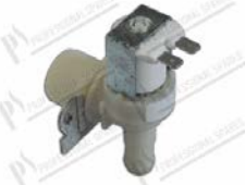
Electrovanne 90° - 1 voie - 220/240V 50/60Hz - Ø 14 mm avec fastons; entrée Ø 3/4" avec filtre et reducteur entrée 20 lt/min; Tmax 90°C
