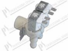
Electrovanne 90° - 2 voies - 220/240V 50/60Hz - Ø 14 mm avec fastons; entrée Ø 3/4" avec filtre; Tmax 90°C
