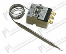
Thermostat d'utilisation 1P 29±82°C capillaire L=900 mm; bulbe Ø 6x145 mm; 15A 400V
