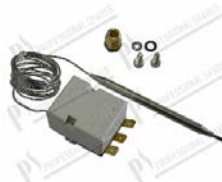
Thermostat d'utilisation 1P 30±90°C capillaire L=1250 mm; bulbe Ø 6x113 mm; 15A 250V
