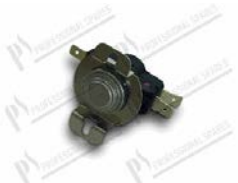
Thermostat à contact 52-60°C 60L50F avec jaune/marron pointe; contact C-2=NC; contact C-1=NO température de travail 30/46°C; 16A 250V
