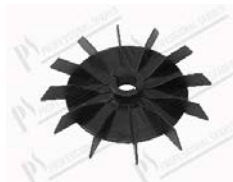
Ventola raffreddamento Ø 142 mm Øint. 15 mm; con fascetta di serraggio
