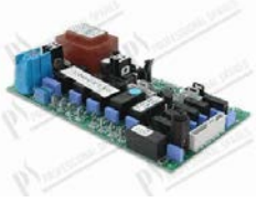
Pcb GET 50.2 dim. 105x183 mm
