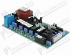
Pcb dim. 105x183 mm
