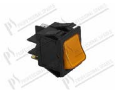
Bouton poussoir orange 22x30 mm 16A 250V; faston 6,3x0,8 mm
