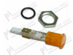
Voyant orange Ø 13 mm 240V - L=60 mm - orange lampe Ø 9 mm, avec écrou et O-ring en silicium
