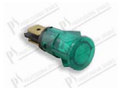
Voyant vert Ø 13 mm 230V - indesserrable lentille Ø 15 mm; L=33 mm; faston 6,3x0,8 mm; Tmax 120°C
