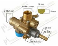
Robinet à gaz avec sécurité PEL 23SV avec veilleuse et bride verticale; entrée M28x1,5 mm - sortie M24x1,5 mm; raccord thermocouple M10x1 mm; D-axe Ø 10x8 mm L=25 mm
