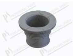
Bonde de vidange Ø 1" 1/2 H=42 mm tuyeau trop-plein Ø 35/32 mm
