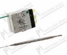
Thermostat d'utilisation 1P 32÷90°C capillaire revêtu L=700 mm; bulbe Ø 6x130 mm
