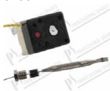
Thermostat de sécurité 1P 125°C capillaire revêtu L=870 mm; bulbe Ø 6,5x68 mm
