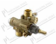
Robinet à gaz avec sécurité PEL 23SV avec veilleuse et bride verticale; entrée M28x1,5 mm - sortie M24x1,5 mm; raccord thermocouple M10x1 mm; D-axe Ø 10x8 mm L=25 mm; vis de min. Ø 2,20 mm
