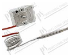
Thermostat de sécurité 1P 30÷150°C capillaire L=850 mm; bulbe Ø 6x70 mm; 16A 400V; à réarmement manuel
