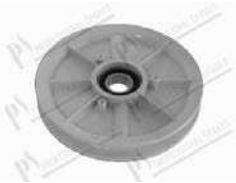
Riemenscheibe Ø 151 mm H=23,45 mm Steinbruch 15 mm; mit lager Ø 20x42x12 mm
