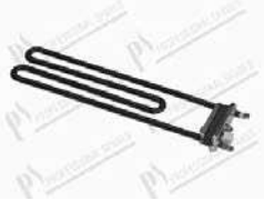
Boilerheizkörper 3000W 240V dim. 350x80mm; mit fühler; faston 6.3x0.8 mm
