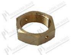
Ecrou 1" 1/4 - laiton H=17 mm; CH50
