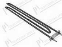
Résistance cuve 1220W 254V dim. 420x64x50 mm; bride 81x28 mm; raccord M4
