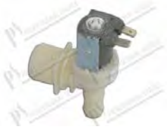
Magnetventile 90° - 1 wege - 24Vac 50/60Hz - Ø 14 mm mit Flachstecker; Eingang Ø 3/4" mit filter; Tmax 90°C
