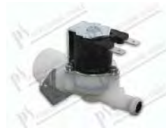
Magnetventile 180° - 1 wege - 24Vdc 50Hz - Ø 10,5 mm mit Flachstecker; Eingang Ø 3/4" mit Filter und Druckverminderer 10 lt/min; ausgang 2,5 lt/min; Tmax 90°C - (RPE)
