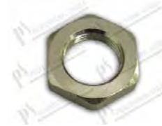
Sechskantmutter 3/8" H=6 mm SW25
