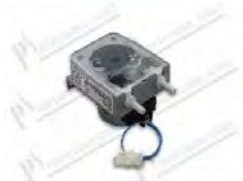
Pumpe Dosiergerät klarspüler fester Durchfluss mod. PG0,4; fester Durchfluss 0,4 L/h; 0,5 bar; 230V 8W; Sekobrillrohr mit Schlauch Øest. 6,3 mm
