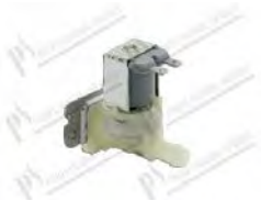
Magnetventile 180° - 1 wege - 24Vac 50Hz - Ø 10,5 mm mit Flachstecker; Eingang Ø 3/4" mit Filter, Tmax 90°C
