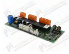
Pcb dim. 240x86 mm; SPUL6 VERSION B MSPL6
