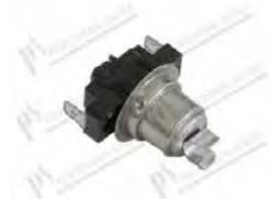
Termostato de seguridad vasca 110°C 1NC; faston 6,3x0,8 mm
