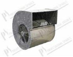
Ventilateur 3 phase 340/370W 230-460V 50/60Hz Ø 250x320 mm; câble L=2150 mm
