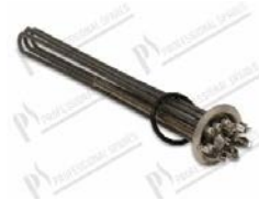
Résistance surchauffeur 6000W 230V L=410 mm; bride Ø 64 mm; Øint. 50 mm; 2 x découpe pour bulbe L=195 mm
