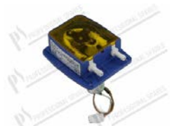
Doseur péristaltique lavage débit fixe mod. PP; débit fixe 7 L/h; 0,1 bar; 24V 3,5W; tuyau in Santoprene ; câble L=205mm
