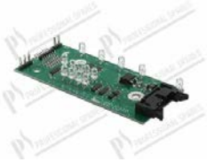
Carte électronique à diodes dim. 57x131 mm
