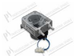
Doseur péristaltique rinçage débit fixe mod. PG0,4; débit fixe 0,4 L/h; 0,5 bar; 230V 8W; Tube Sekobrill avec raccord coudé Øest. 6,3 mm
