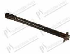
Résistance surchauffeur 10500W 230V L=485 mm; bride 83,5x78,5 mm, Øint. 47 mm; avec portebulbe L=120 mm
