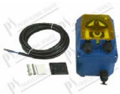
Doseur péristaltique lavage a/regul. vitesse (U. externe) mod. PR-7; avec réglage débit de 1÷7 lt/h press. 0,1 bar; 230V 50Hz protection IP65; tuyau en Santoprene avec raccord embout Ø 5x8 mm; câble L=2750; Kit d'installation inclus
