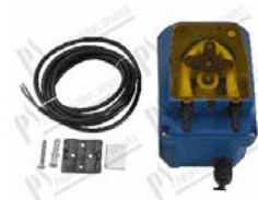
Doseur péristaltique lavage a/regul. vitesse (U. externe) mod. PR-7; avec réglage débit de 1÷7 lt/h press. 0,1 bar; 230V 50Hz protection IP65; tuyau en Santoprene avec raccord embout Ø 6,2x10,2 mm pour agrafe; câble L=2750 mm; Kit d'installation inclus
