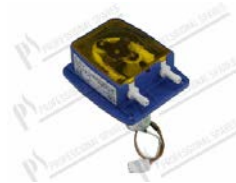
Doseur péristaltique lavage débit fixe mod. PP; débit fixe 7 L/h; 0,1 bar; 24V 3,5W; tuyau in Santoprene ; câble L=205mm
