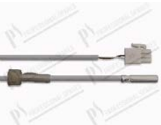
Sonde de température PT1000 bulbe Ø 6,8x32,5 mm; câble L=420 mm
