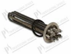
Résistance surchauffeur 3000W 230V L=220 mm; bride Ø 64 mm; Øint. 50 mm; 2 x découpe pour bulbe L=195 mm
