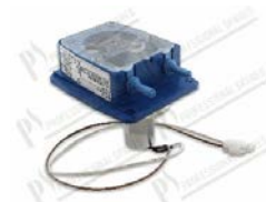
Doseur péristaltique rinçage débit fixe (U. interne) mod. PP; débit fixe 0,5 L/h; 1,25 bar; 24V 50/60Hz; câble L=390 mm; tube in SBR
