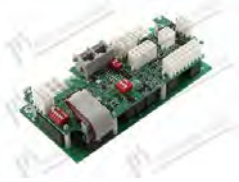
Scheda elettronica MIKE2-E/A1 dim. 75x150 mm
