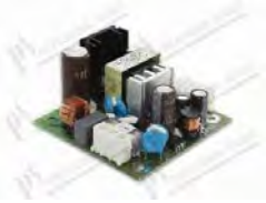
Scheda di alimentazione dim. 80x80 mm
