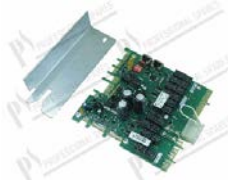
Tarjeta (I/O) dim. 155x145 mm - SCC 61-202
