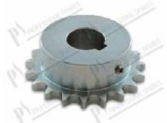
Pignone Ø 82 mm - 19 denti Øint. 25 mm; per chiavetta 8 mm, con grano M6x10 mm
