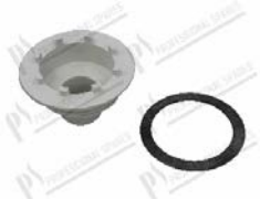
Ablaufventil Ø 109 mm H=61 mm bohrung für überlaufrohr Ø 71/34 mm; Flachdichtung Ø 80x102x2 mm
