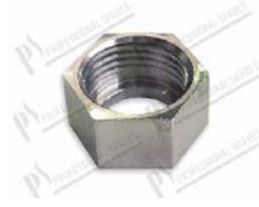
Mutter G1/2" - H=15 mm bohrung Ø 12,2 mm; CH24
