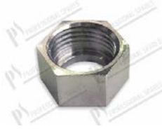
Mutter G1/2" - H=15 mm bohrung Ø 12,2 mm; CH24
