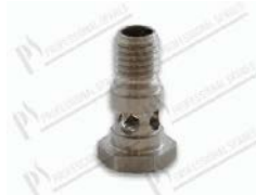
Perno braccio risciacquo superior Ø 14 mm M12; Ltot. 36 mm
