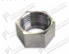
Dado esagonale G1/2" - H=15 mm foro Ø 12,2 mm; CH24
